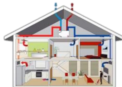
Aanleg balansventilatiesysteem in een woning
